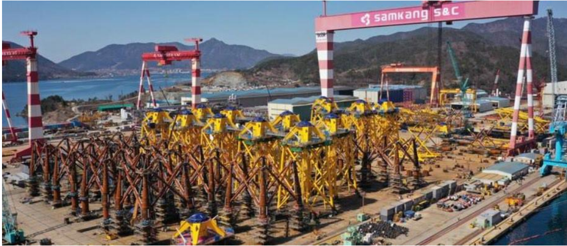
Hình 4-4: Sản xuất móng jacket tại Nhà máy đóng tàu Samkang, Hàn Quốc [6]
