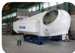
Lắp ráp vỏ bọc
