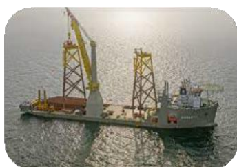
Tàu vận chuyển hàng nặng có hệ thống định vị động DP2
